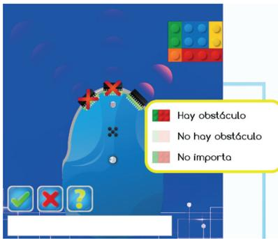
Al escoger la condición de sensor de obstáculo y ubicarla en el diagrama de flujo, se abre el cuadro para configurar los tres sensores. Como vemos en la figura, cada sensor presenta tres posibilidades de configuración: Hay obstáculo, No hay obstáculo o No importa.
