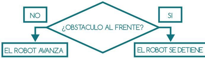
Nuevamente la condición esta en modo de pregunta: ¿Obstáculo al frente?, y el encargado de comprobar la condición es el sensor de obstáculos frontal. Cuando éste detecte un obstáculo dentro del rango de los 12 centímetros entonces la respuesta a la condición será "SI" y el robot tomará la decisión de detenerse.
