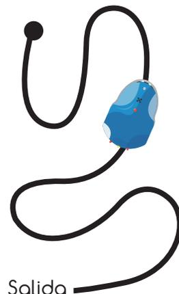
Una vez el recorrido del tramo 1 esté perfecto, el **robot** debe **girar 90 grados** a la **izquierda** para iniciar con el tramo 2, para esto ponemos una velocidad por ejemplo de 100 en la rueda derecha y cero en la rueda izquierda, y además una **demora pequeña** para completar el giro. Nuevamente es necesario cuadrar este tiempo mediante **prueba y error**.
