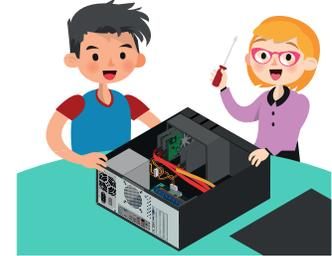
Básicamente, el hardware de un computador está compuesto por la torre o caja, donde se alojan la fuente, la tarjeta madre, la CPU, el disco duro, memorias y otros componentes. También los periféricos de entrada como el mouse, el teclado, cámara web, etc., y los periféricos de salida como el monitor, los parlantes y la impresora.
