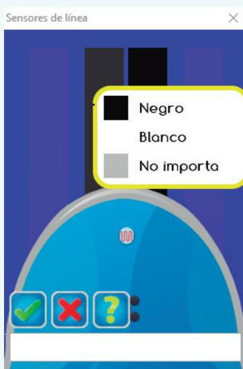
Al escoger la condición de **sensor de línea** y ubicarla en el **diagrama de flujo** se abre el cuadro para configurar los cuatro sensores. Como vemos en la figura cada **sensor** presenta tres posibilidades de configuración: negro, blanco, o no importa.
