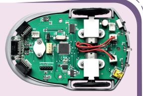
1 Circuitos de control y comunicaciones: Formado principal mente por una placa de circuito impreso donde se alojan todos los componentes electrónicos que controlan las funciones del robot, como los micro-controladores, memoria y otros microchips. Además están las conexiones y el puerto USB para comunicarse con el computador.
